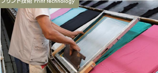
古くから捺染の染工場が集まる京都の土地柄を活かして、ガーメントでのプリント加工を行っております。単純なプリントだけでなく、箔プリントや発泡プリント、オパールプリントなど20種近い特殊プリントが可能です。図案段階から社内のデザイナーが手がけています。
