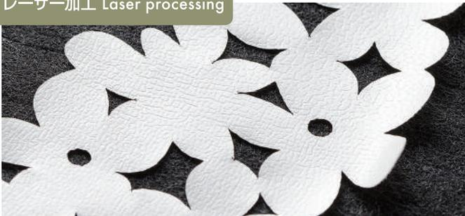
レーザーでは生地を切り抜き柄を作ったり、刺繍に使う土台やアップリケを作ったりしています。基本的に合繊100%の物であれば、なんでも切ることができます。その他、型紙をつくり、作業性をあげるためのツールとしても使われています。
